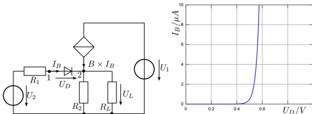
Gegeben ist das (sehr) vereinfachte Ersatzschaltbild eines Transistors in Kollektor (Emitterfolger) Schaltung. Das Ziel ist es, die Ausgangsspannung  $U_L$  zu ermitteln. Die Parameter der Schaltung sind wie folgt:  $R_1 = 10 \text{ k}\Omega$ ,  $R_2 = R_L = 2 \text{ k}\Omega$ ,  $B = 100$ ,  $U_1 = 5 \text{ V}$ ,  $U_2 = 1 \text{ V}$
