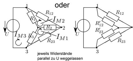
$R_{13}$  liegt parallel zur idealen Spannungsquelle, damit fließen dort  $I_{13} = U/R_{13} = 4,5 \text{ A}$
