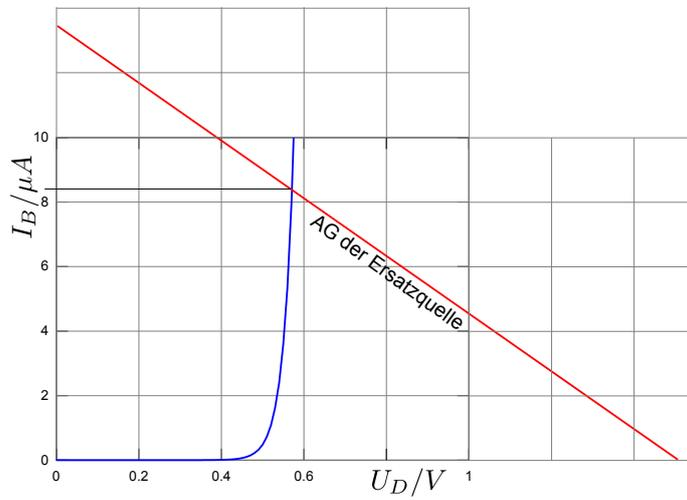
Abgelesen ergibt sich ein Strom von  $I_D = 8,4 \mu A$ , bei nahezu unveränderter Spannung an der Diode. Die Ausgangsspannung ist analog dann mit  $(B + 1)I_B = 101 \times 4 \mu A = 848 \mu A$  dann  $U_L = 0,848 V$ .
