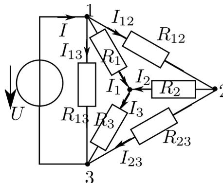
Die skizzierte Schaltung mit den Widerständen  $R_1 = R_2 = R_{23} = 3 \Omega$  und  $R_3 = R_{12} = R_{13} = 1 \Omega$  liegt an der Spannung  $U = 4,5 \text{ V}$ . Bestimmen Sie alle Teilströme!
