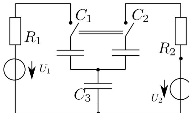
Die Kapazitäten  $C_1 = 3 \text{ nF}$ ,  $C_2 = 5 \text{ nF}$  und  $C_3 = 6 \text{ nF}$  enthalten keine Ladung. Die vorhandenen Spannungsquellen liefern die Spannungen  $U_1 = 120 \text{ V}$  und  $U_2 = 80 \text{ V}$  über die jeweiligen Innenwiderstände  $R_1 = R_2 = 10 \Omega$ .
