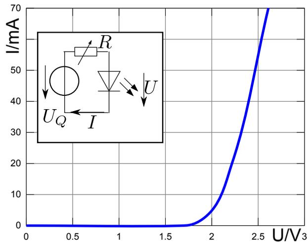
Eine Leuchtdiode in gezeigter Schaltung mit gegebener Kennlinie soll niedrig angesteuert werden. Die Quellenspannung beträgt  $U_Q = 3\text{ V}$ .
