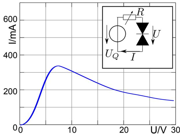
Eine einfache Schaltung mit einem nichtlinearen Element ist vorgegeben. Für die Interessierten: Es handelt sich dabei um eine Gunn-Diode, wie sie zur Erzeugung von Signalen im Mikrowellenbereich oberhalb 10 GHz verwendet werden kann. Diese Schaltung soll dimensioniert werden.
