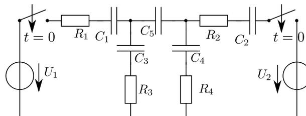
Die beiden Schalter werden zur gleichen Zeit geschlossen. Bestimmen Sie die Spannungen unmittelbar nach Schließen der Schalter und lange Zeit danach. Die Elemente haben die Werte  $U_1 = 10 \text{ V}$ ,  $U_2 = 20 \text{ V}$ ,  $R_1 = R_2 = 1 \Omega$ ,  $R_3 = R_4 = 2 \Omega$ ,  $C_1 = C_2 = 1 \mu\text{F}$ ,  $C_3 = C_4 = 2 \mu\text{F}$ ,  $C_5 = 1 \mu\text{F}$ .
