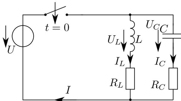
Bestimmen Sie die eingezeichneten Ströme und Spannungen unmittelbar und lange nachdem der Schalter geschlossen wurde.
