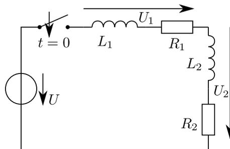
Bestimmen Sie die Spannungen über den (realen) Spulen (Induktivität mit ohmschem Verlust) kurz nach Zuschalten der Quelle und nachdem diese Quelle lange eingeschaltet war.
