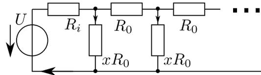
Abbildung 12: Modifikation für eine Quelle mit Innenwiderstand
