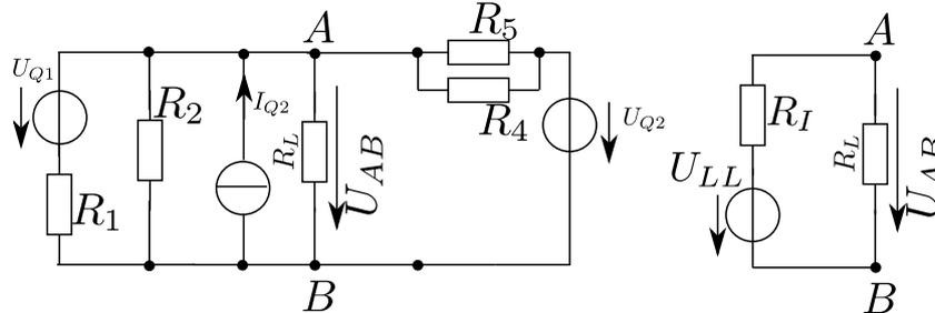
Für die gezeigte Schaltung sind die Verhältnisse an den Klemmen A und B, insbesondere die Spannung  $U_{AB}$ , für beliebige Lastwiderstände  $R_L$  zu bestimmen.
