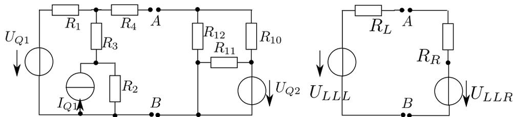
Berechnen Sie die Spannung  $U_{AB}$ . Teilen Sie dazu das Netzwerk an diesen Punkten in einen linken und einen rechten Teil auf und berechnen Sie jeweils die linksseitige und rechtsseitige äquivalente Spannungsquelle. Danach können Sie alles zu einer einfachen Masche wieder zusammenführen und die gesuchte Spannung berechnen. Das Ergebnis darf als Abkürzungen die Parameter der Ersatzquellen enthalten.
