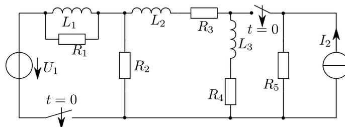
Bestimmen Sie in dem o.g. Netzwerk die Spannungen und Ströme kurz nach dem gleichzeitigen Schließen der Schalter und lange Zeit danach. In letzterem Fall bestimmen Sie auch die auf den Induktivitäten und insgesamt gespeicherte Energie im System. Die Elementwerte sind  $R_1 = 1 \text{ k}\Omega$ ,  $L_1 = 1 \text{ mH}$ ,  $R_2 = 100 \Omega$ ,  $L_2 = 2 \text{ mH}$ ,  $R_3 = 1 \Omega$ ,  $L_3 = 10 \text{ mH}$ ,  $R_4 = 5 \Omega$ ,  $R_5 = 10 \Omega$ ,  $U_1 = 10 \text{ V}$ ,  $I_2 = 1 \text{ A}$ .
