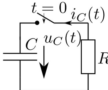
Eine Kapazität mit  $C = 1 \mu\text{F}$  ist auf die Spannung  $U_C = 100 \text{ V}$  aufgeladen. Die Kapazität wird über einen Widerstand  $R = 1 \text{ k}\Omega$  entladen, indem zum Zeitpunkt  $t = 0$  der Schalter geschlossen wird.
