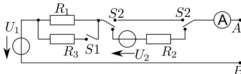
In oben gezeigter Spannungsquelle soll die innere Verschaltung in Abhängigkeit vom entnommenen Strom (Amperemeter mit verschwindendem Innenwiderstand) durch Umlegen der Schalter  $S_1$  und  $S_2$  geregelt werden.
