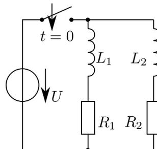
Bestimmen Sie die Spannungen und Ströme bzw. mindestens deren Verhältnis bei den gezeigten zwei parallelen Spulen (Induktivität mit ohmschem Verlust) kurz nach Zuschalten der Quelle
