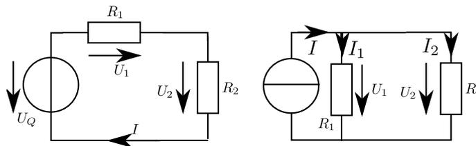
Spannungsquelle (links) und Stromquelle (rechts) mit Innen und Last-Widerstand inklusive der Pfeile für relevante Größen.
