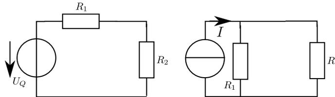
Spannungsquelle (links) und Stromquelle (rechts) mit Innen- und Last-Widerstand.
