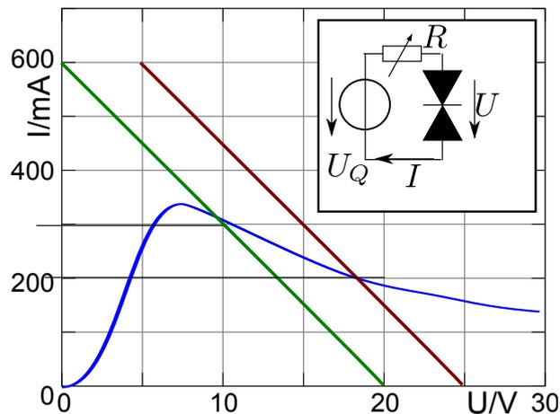
Gemäß Graphik ist ein Kurzschlussstrom von ca.  $I_K = 600\text{ mA}$  notwendig. Daher muss der Innenwiderstand  $R = U_Q/I_K = 33\ \Omega$  betragen.
